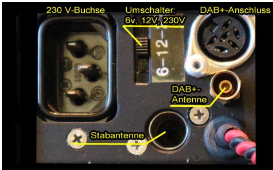
Das Radio kann mit 3 Spannungen betrieben werden:
