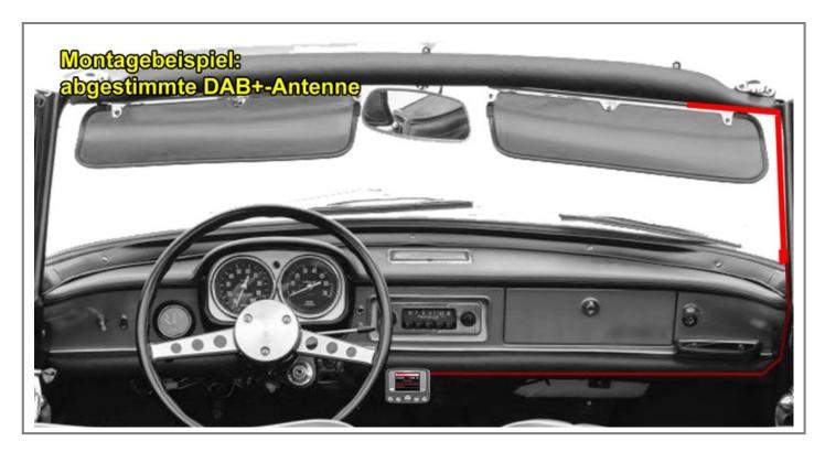
Bei einer gut abgestimmten und positionierten Antenne sollten Sie (je nach Region) 20 bis 100 Sender scannen. Wenn das nicht der Fall ist, sollte man evtl. eine andere Abstimmung der Antenne wählen.
